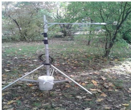
**Slika 1.11.** Instrumenti za merenje bilansa kratkotalsnog i dugotalsnog zračenja u krošnji
