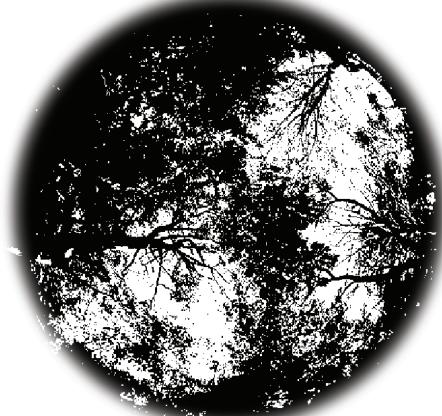
**Slika 1.7b.** Digitalizacija fotografije snimljene "fisheye" kamerom za određivanje dela vidljivog neba na fotografiji. Vidljivo je 44% neba.
